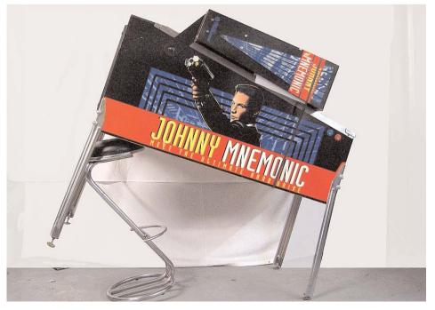
Beine montieren und Stütze wieder entfernen.
