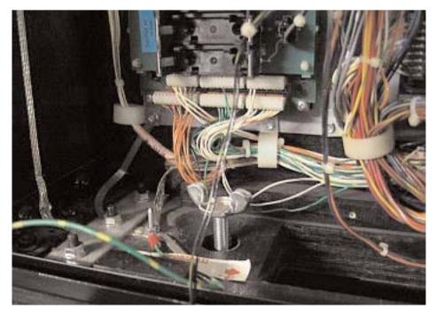
Mit der Flügelschraube wird das Kopfteil zusätzlich gesichert.
