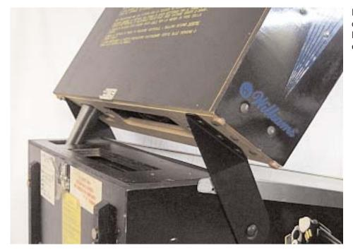
Den Sicherungsgurt entfernen und das Kopfteil aufstellen. Bitte beachten Sie das keine Kabel eingeklemmt werden.
