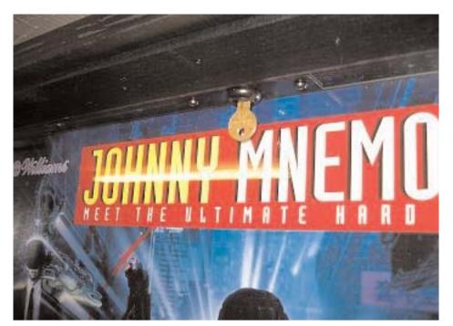
Das Schloss für das Kopfteil befindet sich oberhalb mittig der Buntglasscheibe. Die Scheibe an der Griffleiste nach oben schieben und nach vorn rausheben.
